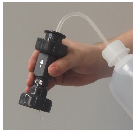
Abbildung 23: Durchflussbegrenzer beim Spülen mit VE-Wasser
